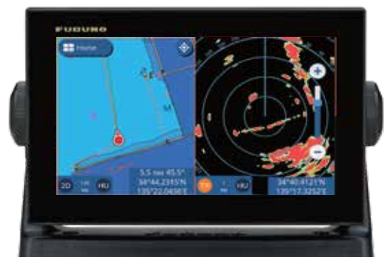
Connexion sans fil entre DRS4W et GP1871F / GP1971F
