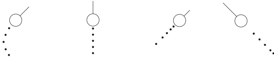
(a) Le bateau vire (b) Le bateau avance en ligne droite (c) Le bateau a réduit sa vitesse (d) Le bateau a augmenté sa vitesse
