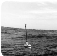
En cas de naufrage, la balise EPIRB1 Pro est automatiquement larguée de son conteneur et flotte à la surface de l'eau. Au contact de l'eau l'EPIRB1 Pro est automatiquement activée.
