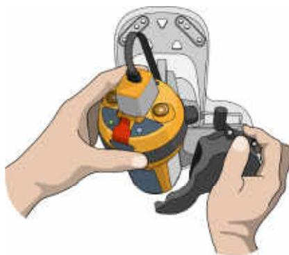
2. Chargez l'EPIRB1 Pro dans son berceau, boutons de contrôle vers le haut, en faisant bien attention à replier l'antenne vers l'arrière de l'EPIRB1 Pro.
